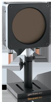
Серия ВD прочная и простая в использовании, просто подключите водяное охлаждение, и вы готовы к работе! Как и наша мощная серия НР, эти отвалы луча имеют высокоустойчивый абсорбер, который может выдерживать несколько кВт в непрерывном режиме. Их очень большая диафрагма диаметром 100 мм вмещает даже самые большие балки.
